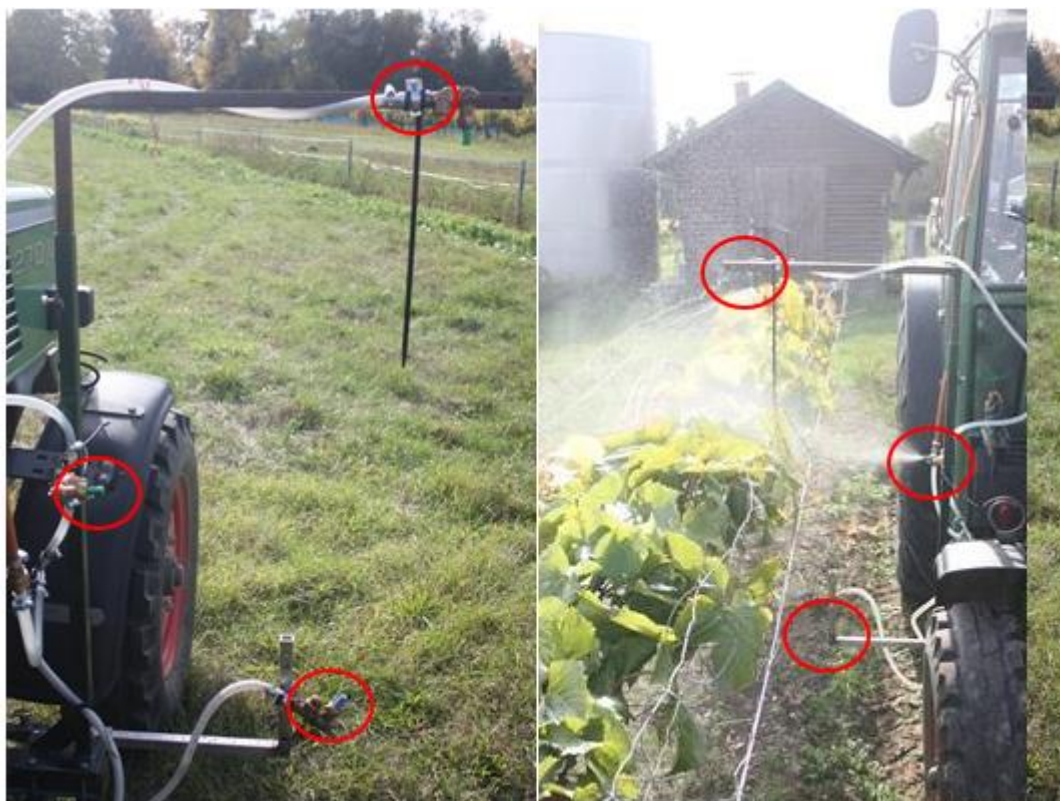
Abbildung 4: Unterlagen Muttergarten : Die Düsen sind rot markiert. Bild links: Spritzgestänge (Eigenbau). Bild rechts: Spritzgestänge beim Pflanzenschutzinsatz im Unterlagen Muttergarten mit Tischerziehung des Versuchsbetriebes Rebenveredlung am DLR-Rheinpfalz.
