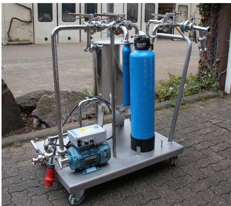
Abb. 1: Regenerierstation mit Ionenaustauscherkartusche, bei der die Säure in einem geschlossenen Kreislauf bleibt.
