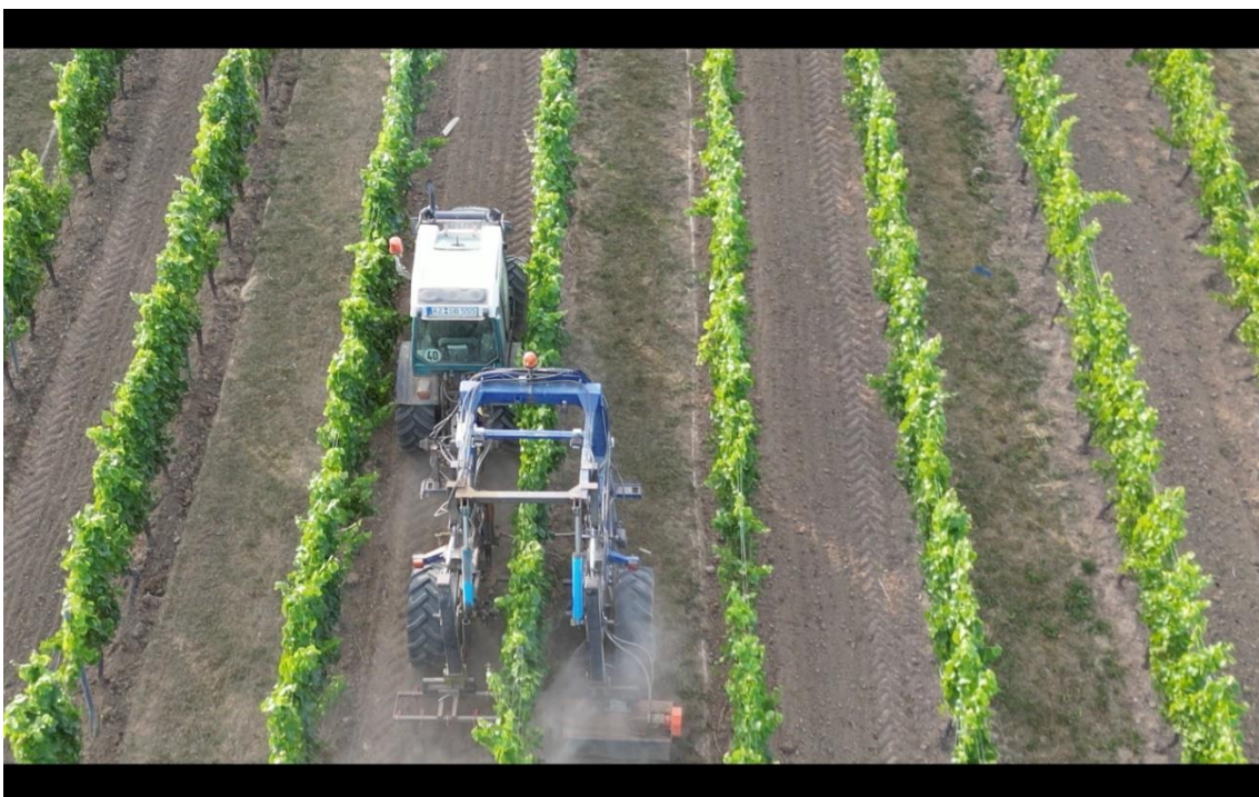
Abbildung 1: Versuchsfahrten mit dem Beiserüberzeilenrahmen und einem angebauten Mulcher (rechts) und einem angebauten Striegel (links) in Kombination
