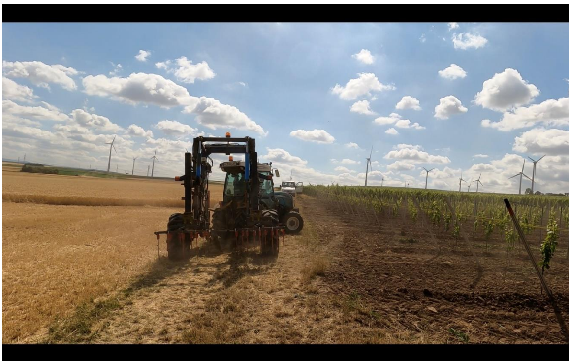
Abbildung 2: Versuchsfahrten mit dem Beiserüberzeilenrahmen und zwei angebauten Striegeln
